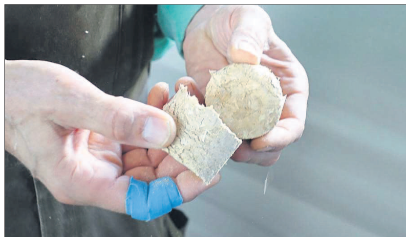
Aus Späne- und Schleifstaubabfall werden Pellets. (Fotos: Klaus Neuhaus)
