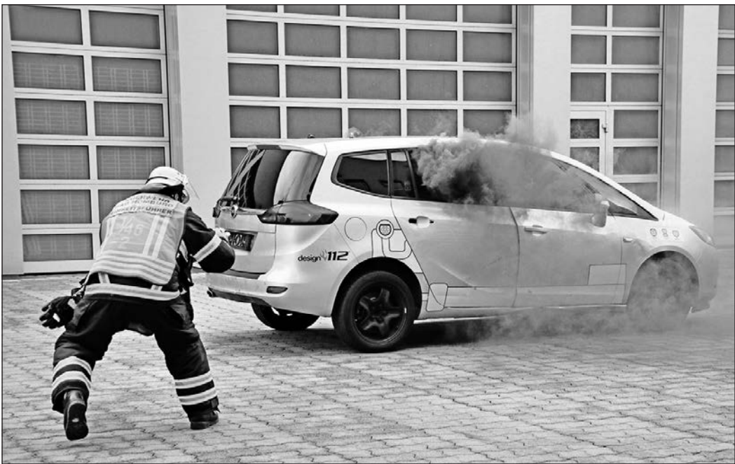
Beim Eintreffen der Feuerwehr erkundet der Wehrführer beim Brand des Autos mit einer Wärmebildkamera, um welche Art von Fahrzeug es sich handelt – eines mit Verbrennungsmotor oder ein Elektrofahrzeug. Foto: Ehmler
