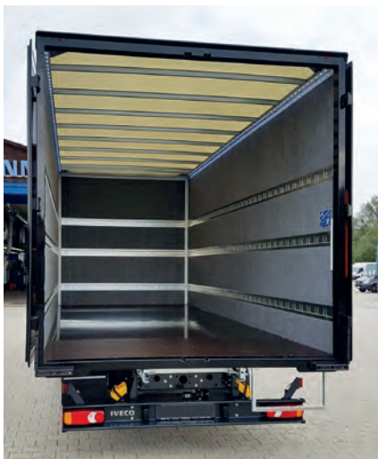
Laderampe eingespart: Die Möbeltreppe ist im Hilfsrahmen versenkt.
