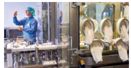
Die Hochtechnologielinie für Biologika (NAPA, New Aseptic Processing Area): Hier werden Insuline bei absoluter Keimfreiheit in Zylinderampullen abgefüllt. (Foto: Sanofi)
