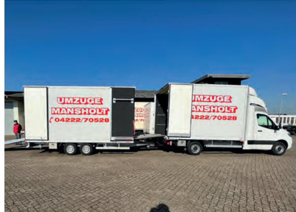
Länge läuft eben: Die beiden Möbelkoffer werden durch eine breite Transportschiene verbunden und lassen sich so in einem Rutsch beladen.
