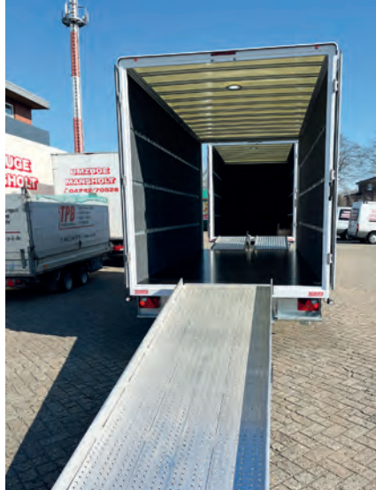
Länge läuft eben: Die beiden Möbelkoffer werden durch eine breite Transportschiene verbunden und lassen sich so in einem Rutsch beladen.
