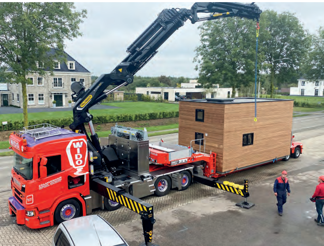
Muss man haben: Der Auflieger wird an eine Scania-Zugmaschine mit fest montiertem Palfinger-Kran angedockt.
