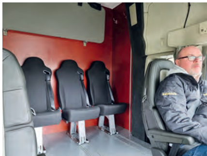
Gut zu erkennen: Vor den vier Sitzen in zweiter Reihe sind Schienen eingelassen, damit die Sessel sich in eine bequeme Liegeposition verschieben lassen.
