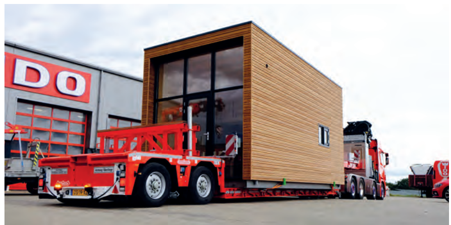
Gilt nicht nur auf dem Fußballplatz, sondern auch auf dem Speditionshof: Mit einer Ladeflächenhöhe von nur 25 Zentimetern kommt der Nootboom-Auflieger ausgesprochen flach rein.
