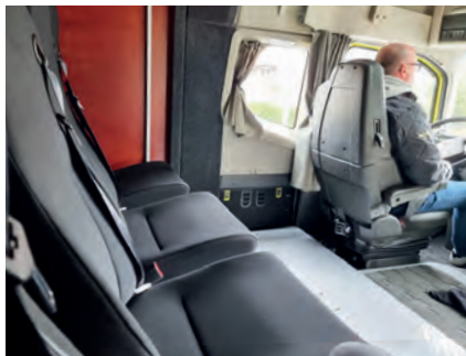
Gut zu erkennen: Vor den vier Sitzen in zweiter Reihe sind Schienen eingelassen, damit die Sessel sich in eine bequeme Liegeposition verschieben lassen.
