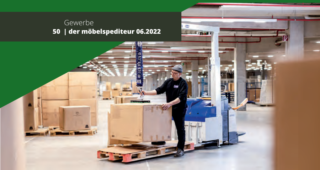
Entlastet die Jysk-Lagermitarbeiter spürbar: Mit einem mobilen Vakuumheber werden die verpackten Möbelstücke verladen.
