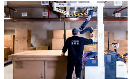
Entlastet die Jysk-Lagermitarbeiter spürbar: Mit einem mobilen Vakuumheber werden die verpackten Möbelstücke verladen.
