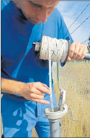
Marcin Tix, Leiter der Wasserversorgung Gemeindewerke Budenheim – AöR beim Messen des Grundwasserpegels am Brunnen II.
