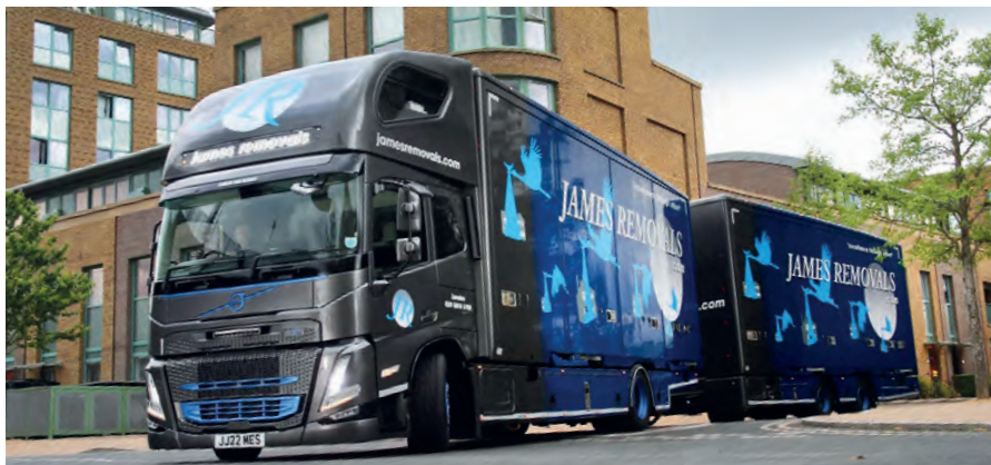
Geht in die Verlängerung: Mit Deichselachse wird bei Bedarf ein Anhänger angeklemmt.
