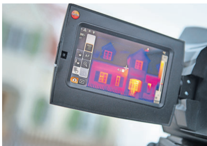
Den energetischen Zustand des Hauses untersuchen: Ein kalter Wintermorgen ist ideal für Aufnahmen mit einer Wärmebildkamera. Foto: Tobias Hase/dpa-mag
