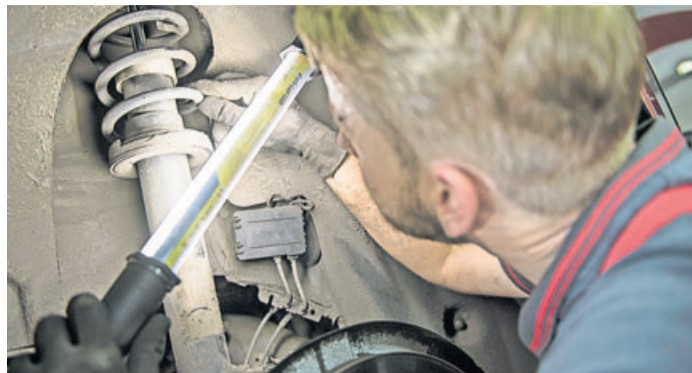
Taugen die noch? Ja, sieht gut aus. Diese Stoßdämpfer sind noch in Schuss und beeinträchtigen die Funktion von ESP und Co. nicht. Foto: Robert Günther/dpa-mag
