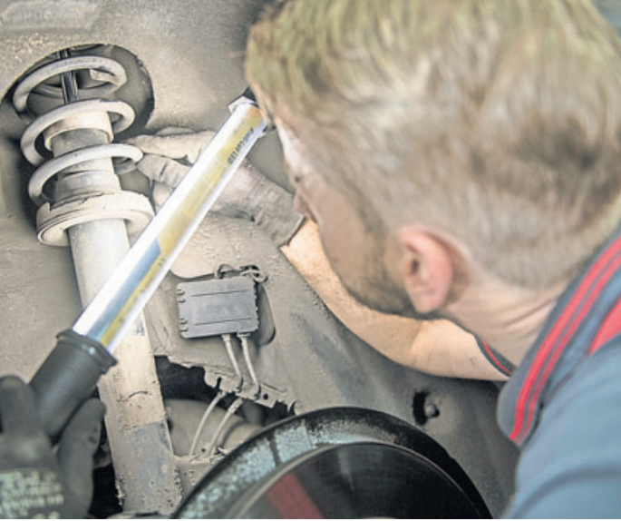
Taugen die noch? Ja, sieht gut aus. Diese Stoßdämpfer sind noch in Schuss und beeinträchtigen die Funktion von ESP und Co. nicht. Foto: Robert Günther/dpa-mag
