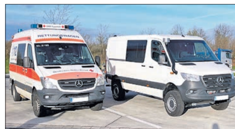
Aktueller Rettungswagen und zukünftiges Einsatzfahrzeug im Vergleich; zu erkennen sind der höhere Radstand, die größeren Räder und der Topf der Luftansaugung Foto: DRK Eppstein
