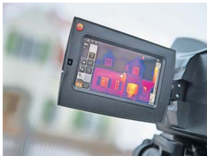
Beim Thermographie-Verfahren werden mit Wärmebildkameras die Oberflächentemperaturen der Außen- und Innenwände erfasst und darstellbar gemacht. Das Ergebnis sind bunte Bilder, die anzeigen, an welchen Stellen Wärme verloren geht und wo das Gebäude gut isoliert ist. Foto: Tobias Hase/dpa-mag
