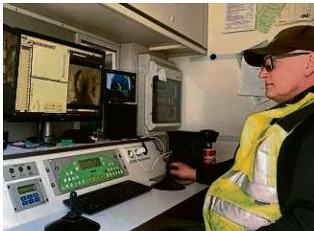
Alles im Blick: Auf drei Monitoren wird Inspektor Ralf Kahlert von der von ihm ferngesteuerten Kamera mit Bildern aus dem Kanalsystem versorgt. FOTO: THOMAS SEIFERT
