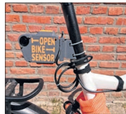
Der Openbike-Sensor wird an der Sattelstange montiert.
