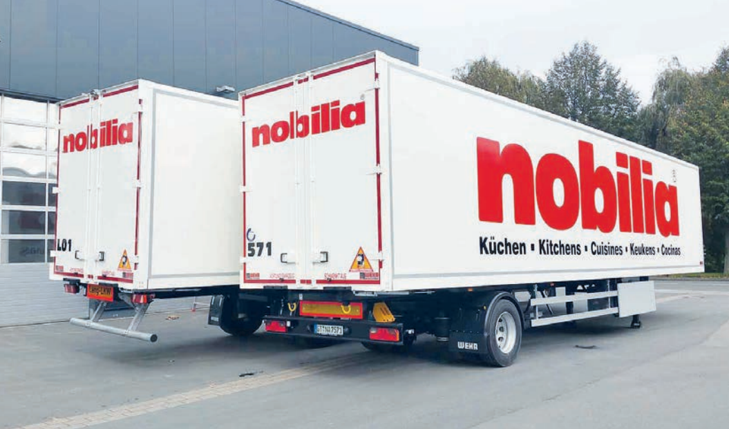
Vertraute Optik mit Tunnelblick: Der Lang-Auflieger Typ 1 mit dem Kofferaufbau für Möbeltransporte (Vergleichsbild r. mit einem normalen Auflieger).
