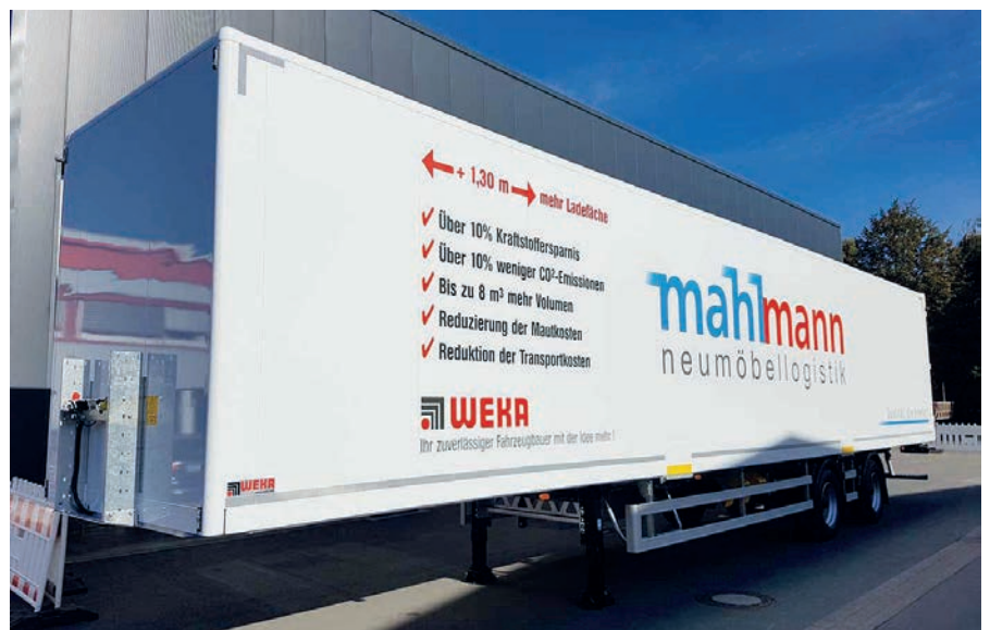
Schienenfan: Der Lang-Auflieger Typ 1 mit Kofferaufbau und Airlineschienen ist bahnverladbar.
