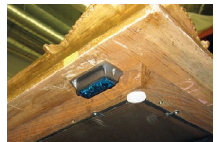
Ein an der Rückseite des Zierrahmens eines realen Gemäldes befestigter MSR165 zur Aufzeichnung der Immissionen.
