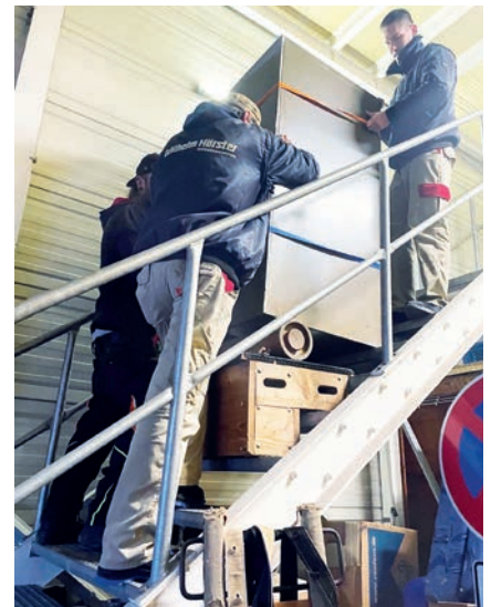
Kostet fast nichts in der Anschaffung, lässt sich aber effektiv und sicher nutzen: Richtig angewendet ist der Treppentransport mit Stufensetzer einfach.
