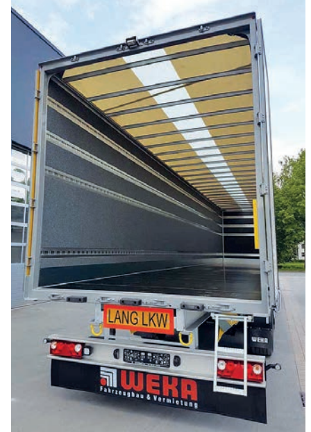
Vertraute Optik mit Tunnelblick: Der Lang-Auflieger Typ 1 mit dem Kofferaufbau für Möbeltransporte (Vergleichsbild r. mit einem normalen Auflieger).
