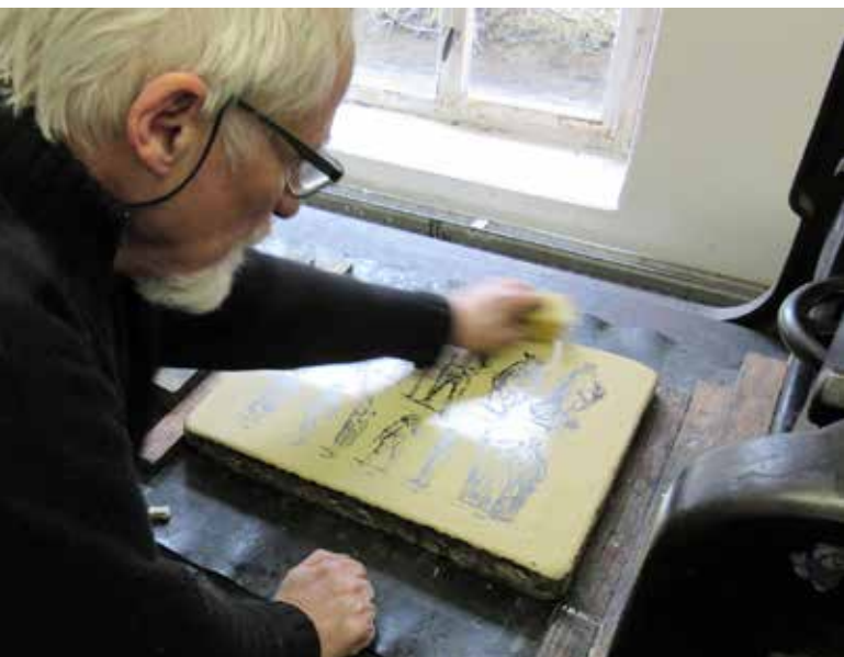
Der Litho-Stein wird angefeuchtet
