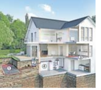
Heizen per Erdwärme: 1 - Erdkollektoren, 2 - Verteil- und sammelstation, 3 - Fußbodenheizung, 4 - Wärmepumpen. Grafik: August Brötje GmbH / BHW Bausparkasse
