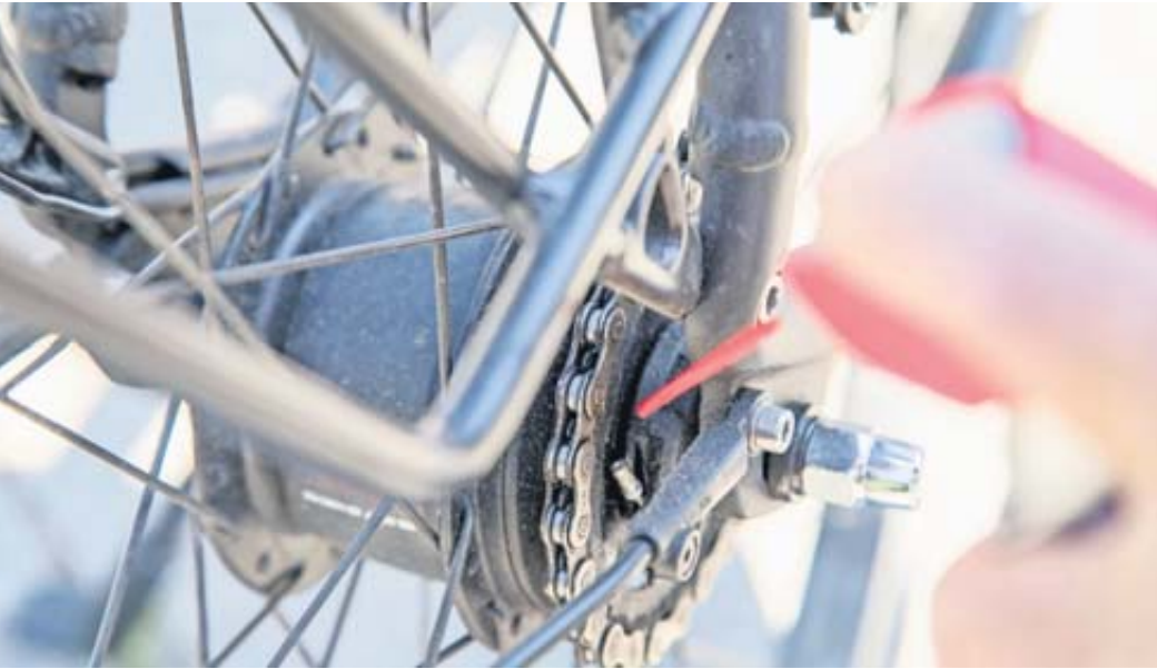
Ein guter Tropfen: Mit speziellem Kettenöl läuft die Kette nach der Reinigung wieder wie geschmiert. Foto: Christin Klose/dpa-mag
