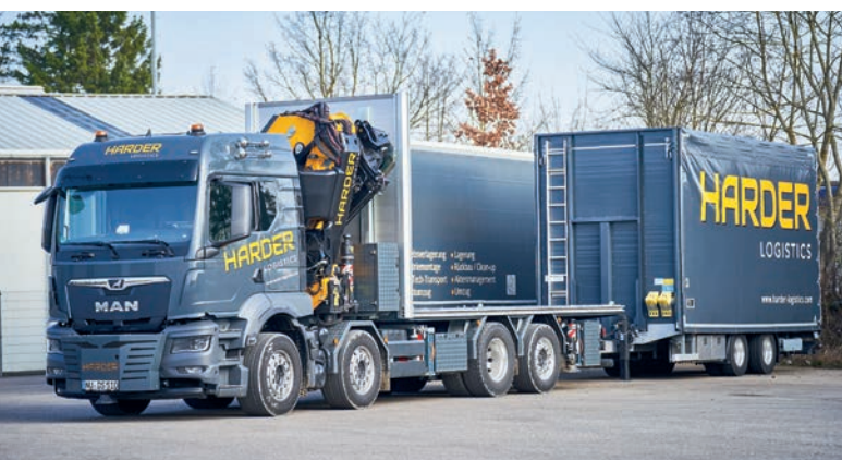
Äußerst gelenkig: Das 360-Grad-Ladekran-Fahrzeug ist eine Sonderanfertigung mit einer Ausladung von 28 Metern.
