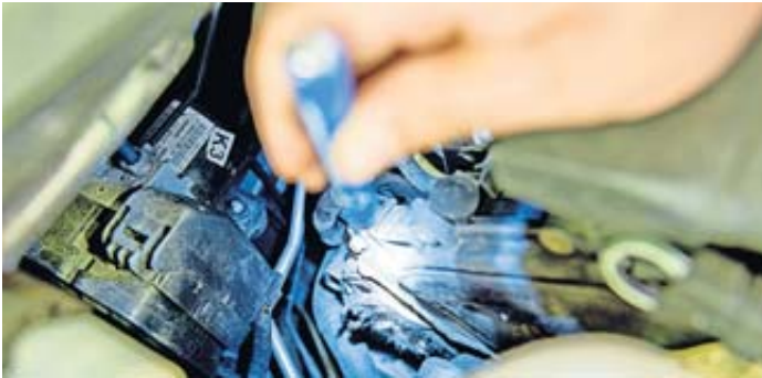
Sieht stark nach Marderbesuch aus. Angefressene Schläuche und Abdeckungen sind stumme Zeugen des nächtlichen Marderwütens im Motorraum. Foto: Inga Kjer/dpa-mag
