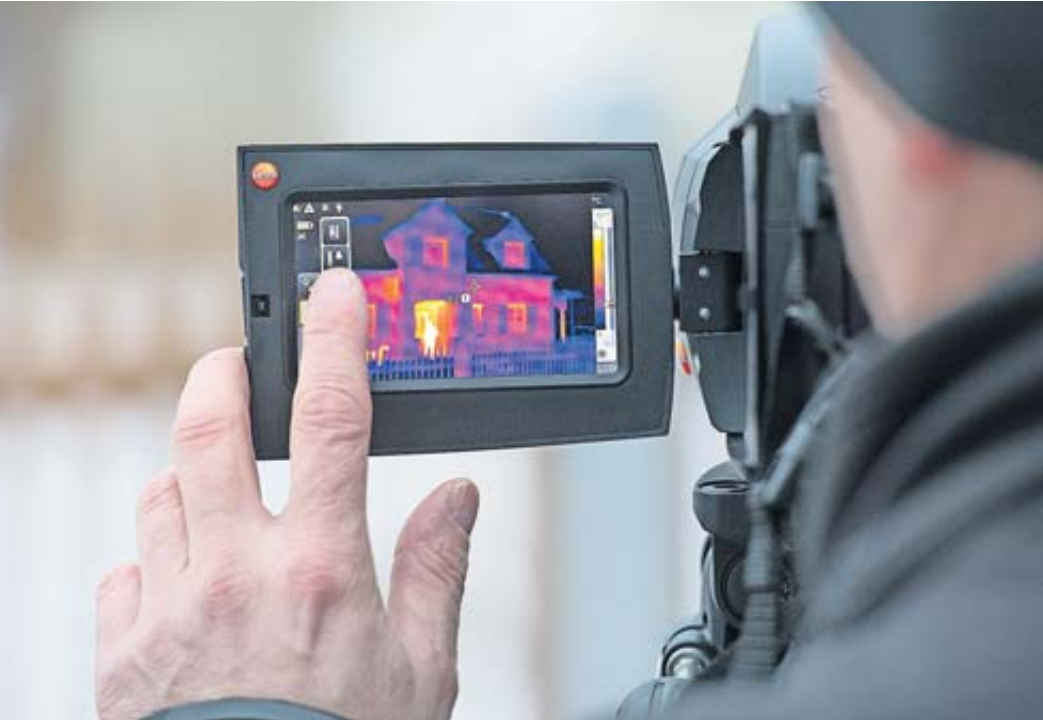
Die Thermographie zeigt das Haus in intensiven Farben, die für die Temperaturen der Bauteile stehen. Gelb bis rot sind die Stellen, an denen viel Wärme von innen entweicht. Wo das Bild blau oder grün gefärbt ist, ist die Oberfläche kälter und es dringt weniger Wärme nach außen. Foto: Tobias Hase/dpa-mag
