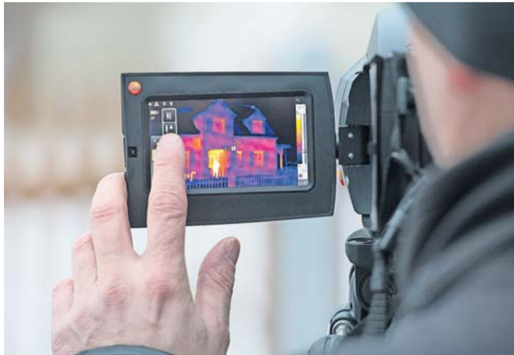
Die Thermographie zeigt das Haus in intensiven Farben, die für die Temperaturen der Hausteile stehen. Gelb bis rot sind die Stellen, an denen viel Wärme von innen entweicht. Wo das Bild blau oder grün gefärbt ist, ist die Oberfläche kälter und es dringt weniger Wärme nach außen.
