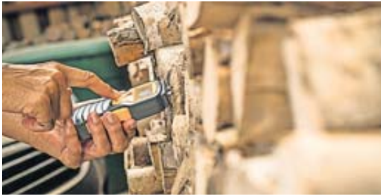
Ist das Brennholz trocken genug? Das lässt sich mit speziellen Feuchtigkeitsmessern feststellen.
