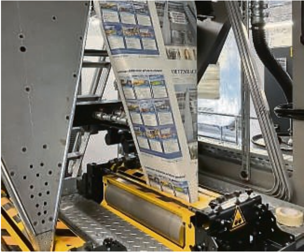
Der entscheidende Moment: Die Zeitungssseiten werden nach dem Druck gefalzt und geschnitten.
