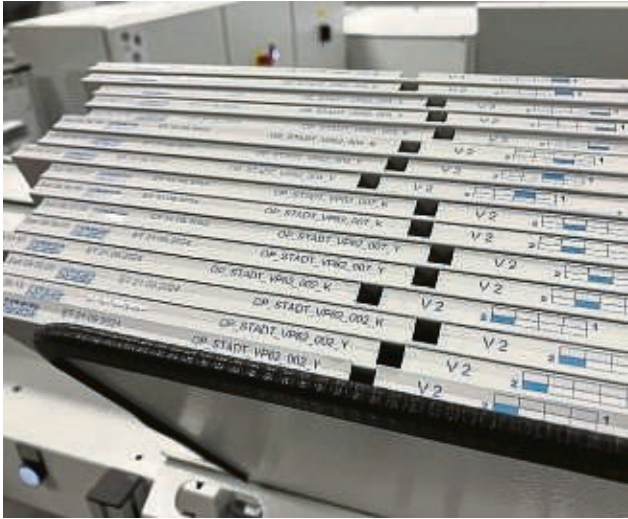
Die Druckplatten werden von der neuen CTP-Anlage automatisch sortiert.
