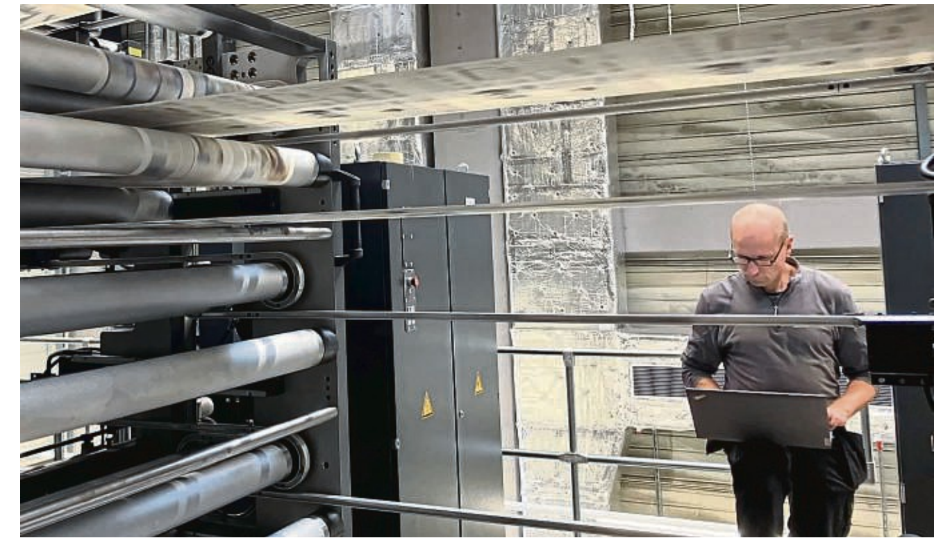
Mit einer Geschwindigkeit von bis zu 55 000 Zeitungen pro Stunde läuft die neue Druckmaschine. Aktuell werden Details überprüft und eingestellt.
