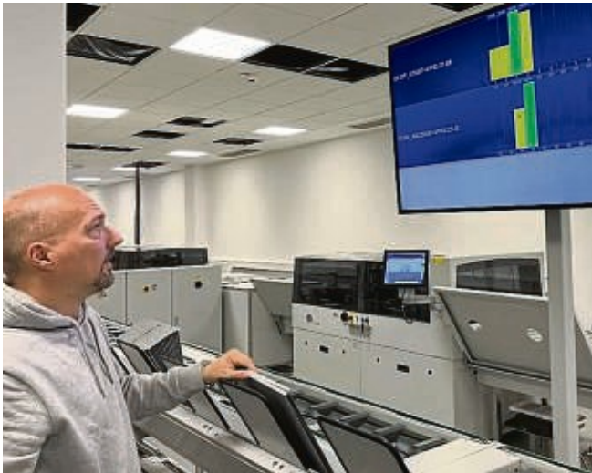
Auf dem Monitor verfolgt Heiko Große in der Druckvorstufe den Stand der Plattenbelichtung in Echtzeit. Am neuen Leitstand (rechts) gibt es weder Tastatur noch Maus: Die Maschine wird – wie hier von den Druckern Dirk Stumpp und Christiane Wanke – per Touchpad gesteuert.
