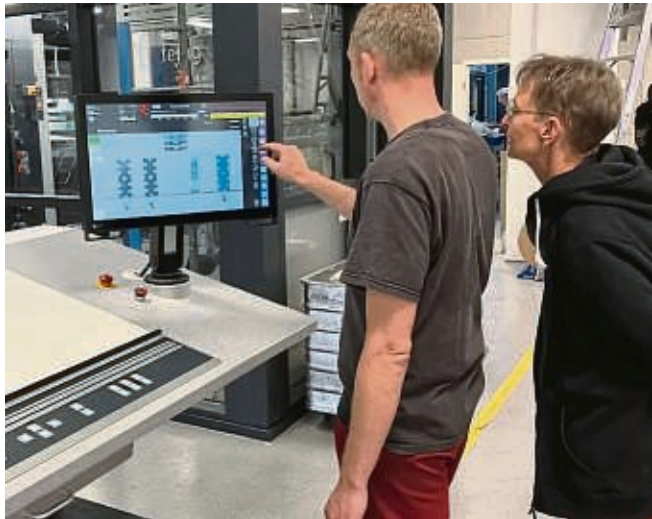
Auf dem Monitor verfolgt Heiko Große in der Druckvorstufe den Stand der Plattenbelichtung in Echtzeit. Am neuen Leitstand (rechts) gibt es weder Tastatur noch Maus: Die Maschine wird – wie hier von den Druckern Dirk Stumpp und Christiane Wanke – per Touchpad gesteuert.
