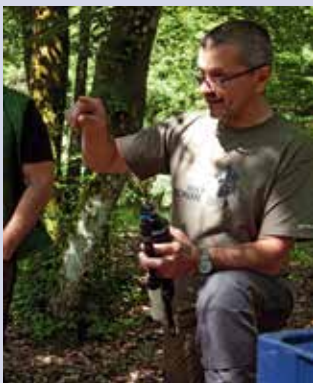
Karl Schwebel erklärt das Multifunktionsmessgerät zur Messung von PH-Wert, Leitfähigkeit, Sauerstoff und Wassertemperatur Foto: Michael Schröder
