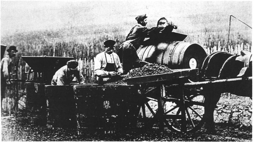
Abb. 17: Standbütten mit Traubenmühle, Tischauslese und Ladfaß. Quelle: Theo Becker, Weinbau anno dazumal. Neustadt 1983, Abb. 14, S. 119.
