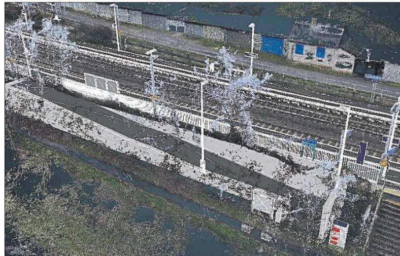
Visualisierung der Verkehrsstation Lorchhausen mit stufenfreier „Schweizer Rampe“ und neuer Treppe. Der Fahrkartenautomat soll am Fuß der Treppe platziert werden.
