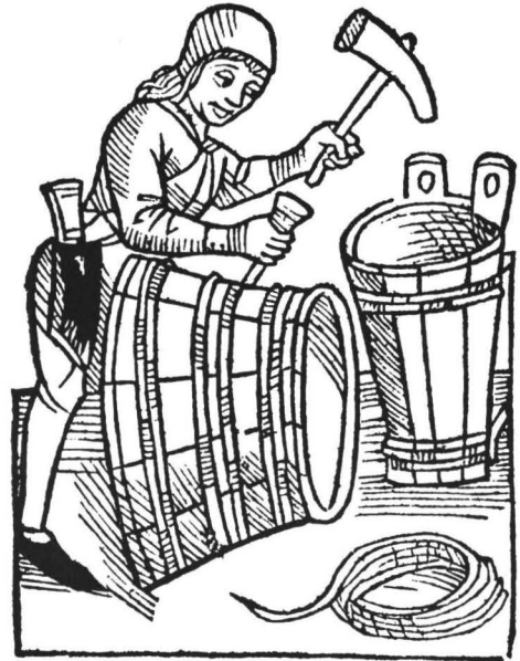
Abb. 4: Ein Faßbinder bei der Arbeit mit einem schlanken, konisch-asymmetrischen Schlegel. Aus Petrus des Crescentiis, Commodorum ruralium libri , gedruckt bei Peter Drach, Speyer um 1490. Reproduktion: Germanisches Nationalmuseum Nürnberg
