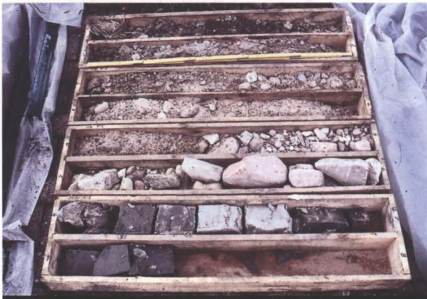
Abb. 4: Bohrproben vom rheinnahen Ufer bei Frei-Weinheim. Länge der Kisten 1 m. Das Profil beginnt links oben mit der Grasdecke. Es folgen Auenlehm- und -sand bis 4,4 m, dann grober Kies der Niederterrasse und ab 6,0 m grauer Ton der Tertiärzeit.
