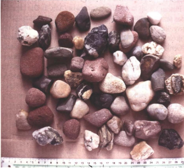
Abb. 3: Kies der Rhein-Niederterrasse aus Bohrungen bei Frei-Weinheim.
