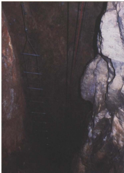
Abb. 3: Blick in den 25-m-Blindschacht im steil stehenden Quarzgang.
