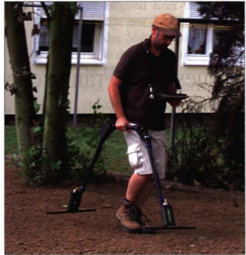
Abb. 3: Begehung mit dem Boden-Radar
