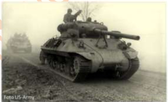
Ab Mitte 1944 eingesetzte 29 t US-Jagdpanzer M36, mit 90 mm Kanone, Chassis auf Basis des Kampfpanzers M4
