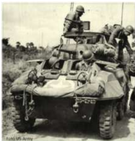
Panzerspähwagen M8 „Greyhound“, mit 4 Mann Besatzung, 37 mm-Kanone und 12,7 mm-Maschinengewehr im Kranz des offenen Turms - Die oftmals ersten Vorboten der US-Truppen
