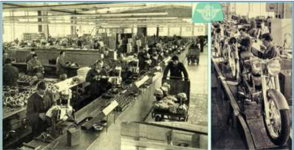
1954 - Alle sieben Minuten laufen ein Motor und eine Regina von den neuen Montagebändern in der 1953 neu errichteten großen Werkhalle Quelle: HOREX Hauspost Ausgabe 54-1
