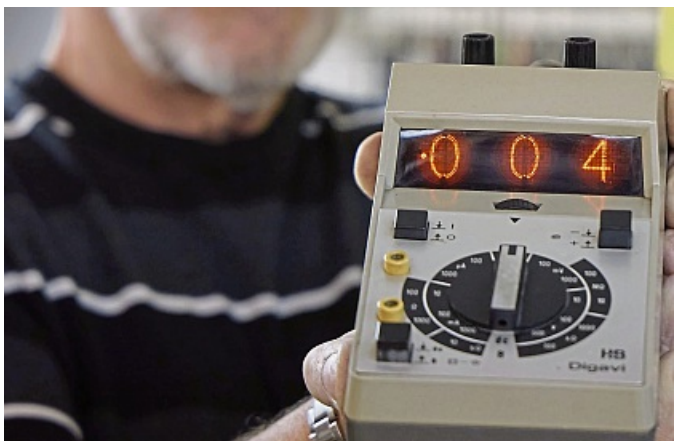
Eines der weltweit ersten digitalen Multimeter, das Digavi von Hartmann & Braun.
