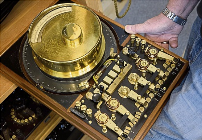
Das Kaiserliche Telegraphen-Versuchsammt ließ 1898 Instrumente zur Qualitätsmessung von Telegraf- und Telefonleitungen bei Siemens bauen. Dieses Exemplar soll von der Reichspost jedoch nie benutzt worden sein.
