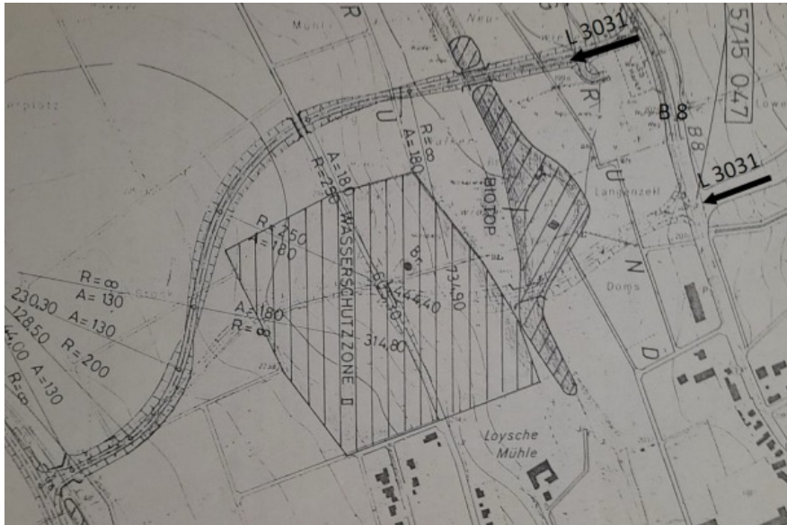
Abb. 4 Trassenvariante Bauabschnitt II L 3031 - 1982
