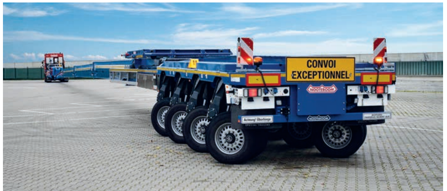
Für Langläufer wie ihn wurden querformatige Bilder erfunden: Der „Superwing Carrier XL“ von Noteboom lässt sich dank intern verlegter Leitung wie ein Ziehharmonika aus- und einfahren.
