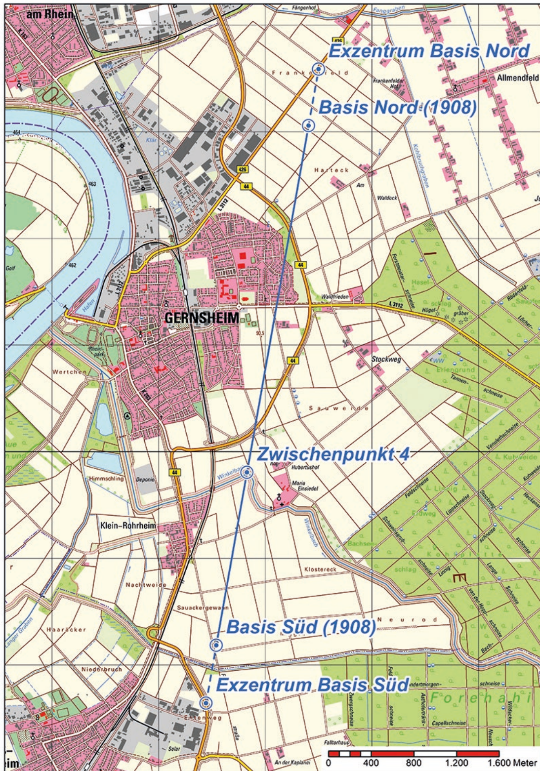
Lageplan der Basis bei Gernsheim mit den oberirdisch festgelegten Exzentren (HLBG 2010) (Grafische Gestaltung: Alexander Hoff, HLBG)
