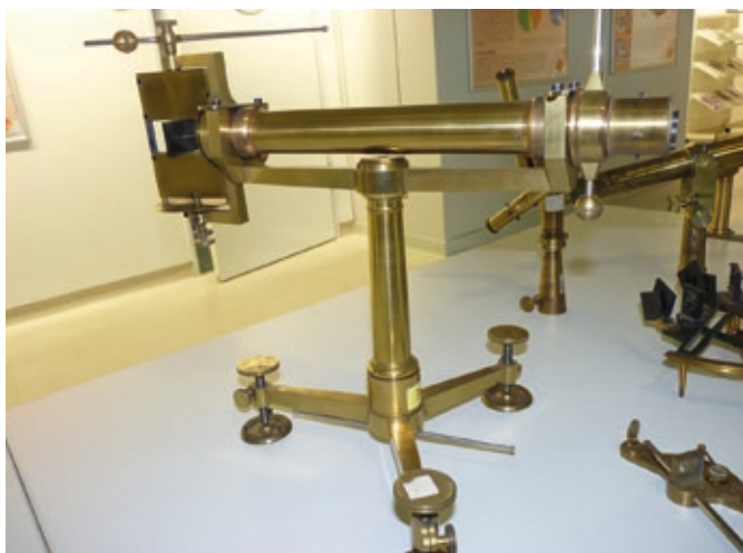
Heliotrop von F. W. Breithaupt von 1843 (Foto: Joos Tenbrieg, Marburg)
