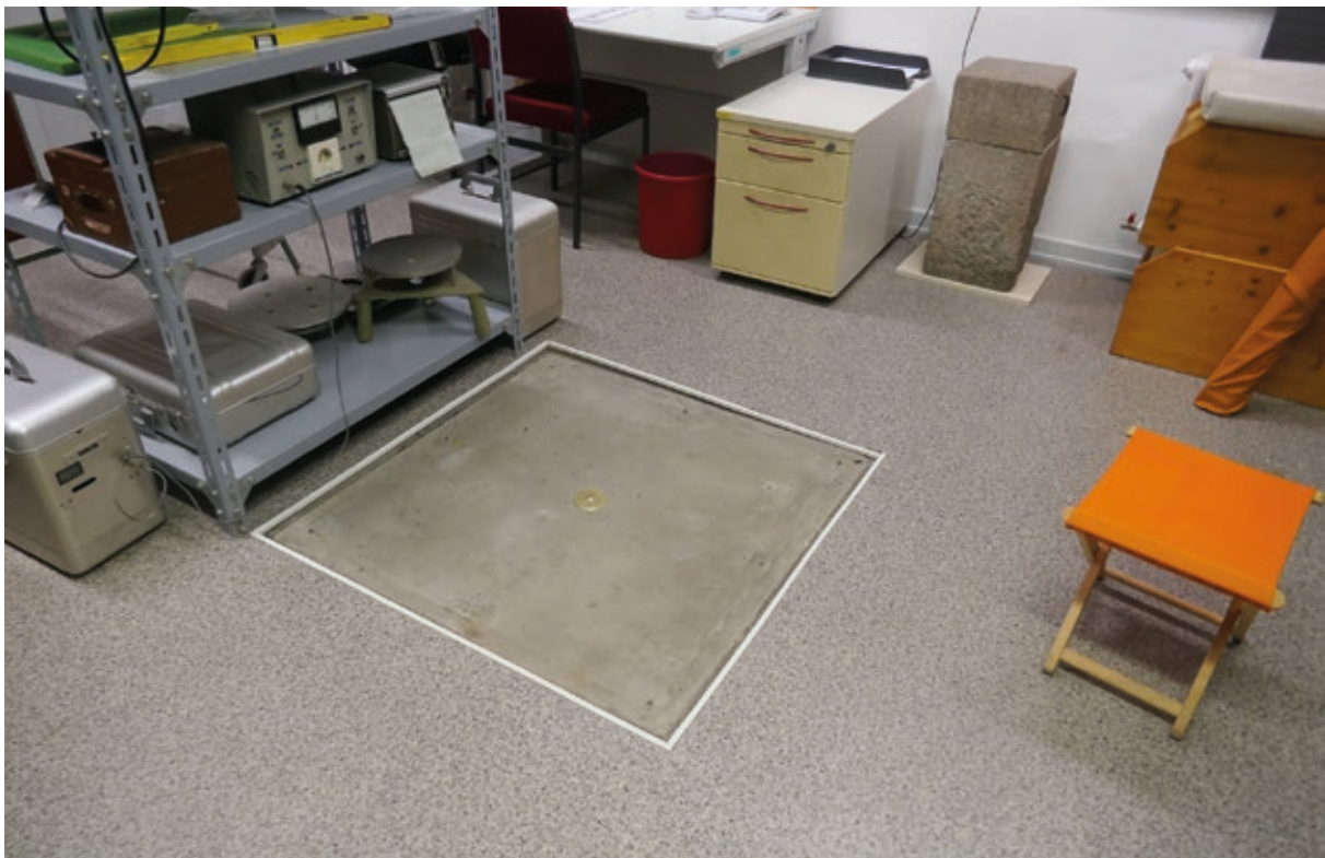
Gravimeterraum und Schweregrundnetzpunkt im HLBG
