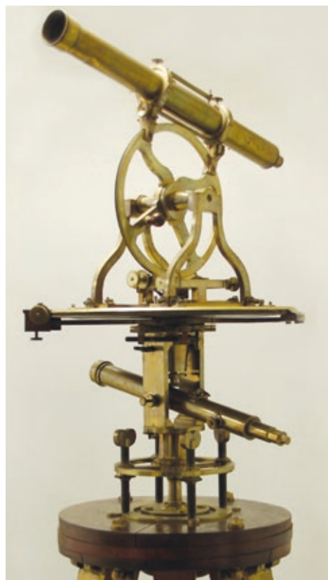
Fräser-Theodolit (Foto: HLBG)
