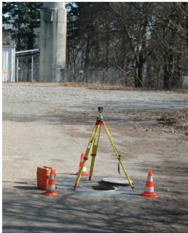
Das Punktzentrum – die Platte im Kanalschachtring (Foto: HLBG Wiesbaden)
