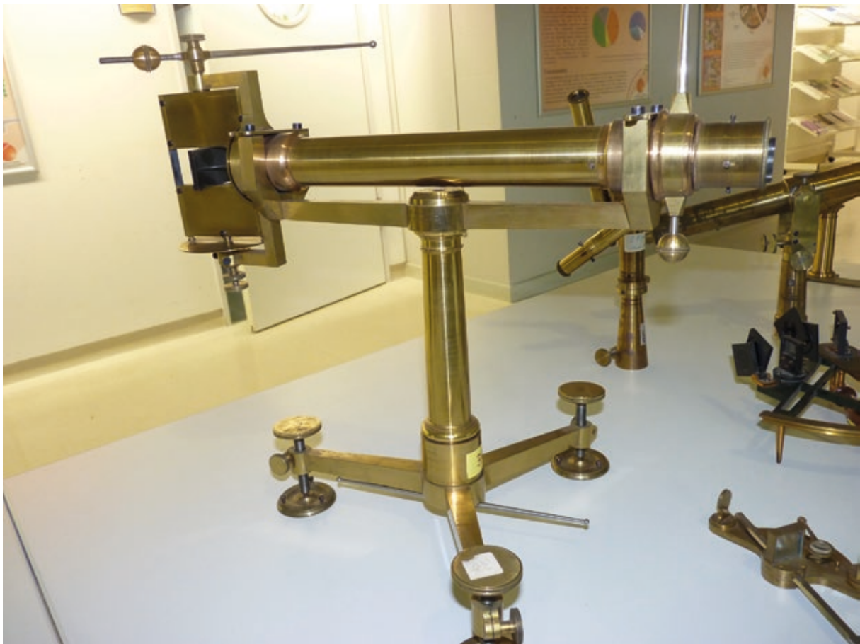
Abb. 2: Heliotrop von F. W. Breithaupt & Sohn in Kassel aus dem Jahr 1843 (Foto: Joos Tenbieg, Marburg)
