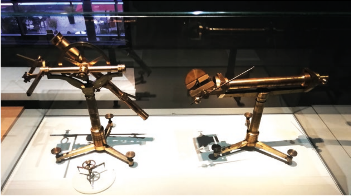
Abb. 7: links der Rumpf-Heliotrop erster Bauart von 1821, rechts der Rumpf-Heliotrop zweiter Bauart von 1824. Der Heliotrop zweiter Bauart (rechts im Bild) ist etwa 40 cm lang und etwa 25 cm hoch, also etwas kleiner als der Breithaupt-Heliotrop von 1843 in Abbildung 2.
