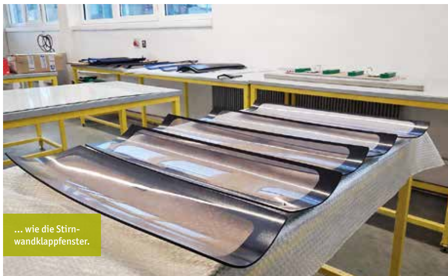
Die Scheiben der C10-Kabine bestehen ebenso aus PET-G ...
