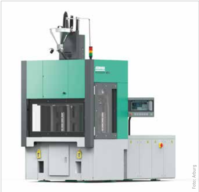
Die neue energieeffiziente und platzsparende Vertikalmaschine Allrounder 475 V von Arburg eignet sich sowohl für das manuelle als auch automatisierte Umspritzen von Einlegeteilen.
