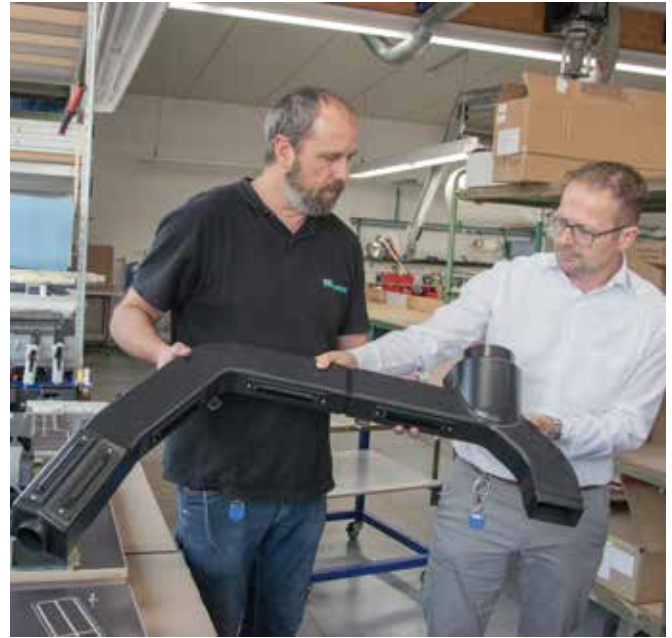
Der Luftkanal für ein Nutzfahrzeug besteht aus drei Teilelementen. Jedes Teilelement besteht aus drei oder vier Thermoform-, Fräs- und 3D-FDM-Druck-Bauteilen, jeweils aus ABS-V0.
