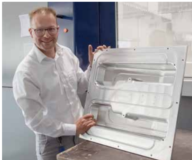
Die temperierten Thermoformwerkzeuge stellt Huber grundsätzlich im eigenen Haus her.
