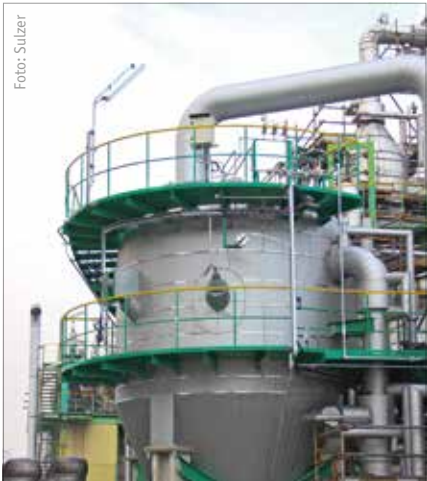
Die Entgasungsanlage DEVO von Sulzer erreicht eine Polymerreinheit von über 99,9 Prozent.
