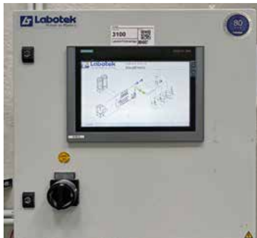
Die Labonet-Steuerung visualisiert alle Wege des Pulvers vom Silo und des Granulats vom Bigbag bis zu jedem einzelnen Extruder.
