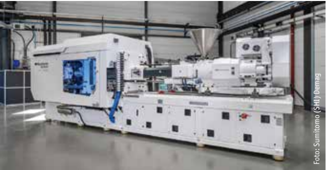
Der Schnellläufer Pac-E von Sumitomo (SHI) Demag in der neuen Schließkraftgröße 4.200 kN fertigt auf der K 2025 Medizinbecher.
