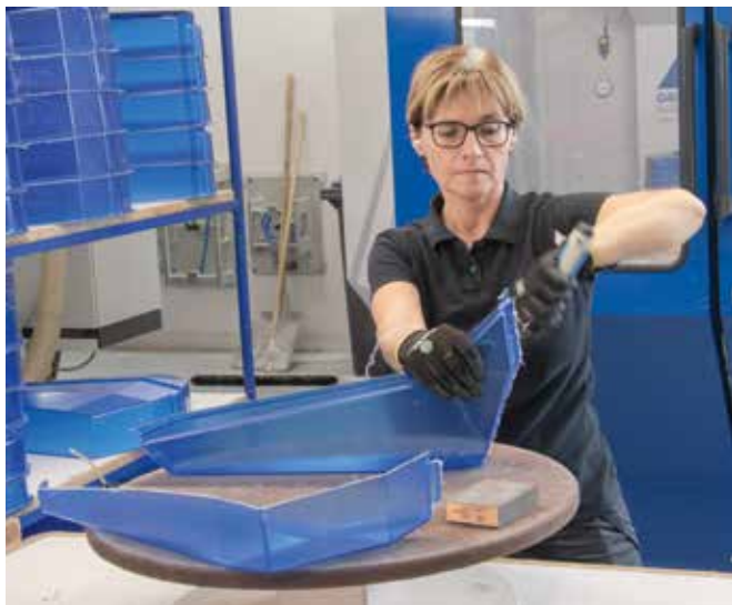
Die auf einer 5-Achs-CNC besäumte, thermogeformte Leuchtenabdeckung aus transparentem PC entgratet eine Mitarbeiterin im Anschluss manuell und nimmt die Qualitätsprüfung vor.
