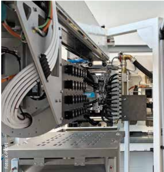
Das Automationskonzept von micro automation basiert rein auf Lineartechnologien. Die Wiederholgenauigkeit zeigt eine 96-fach-Anwendung für Nadel-Schutzkappen.
