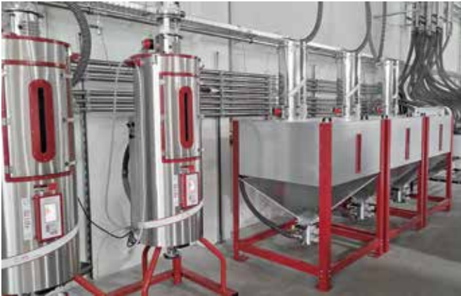
Die qip-Zweikreis-Granulattrockner von Wenz sind mit einem Behältervolumen zwischen 1,5 und 5.500 l verfügbar.
