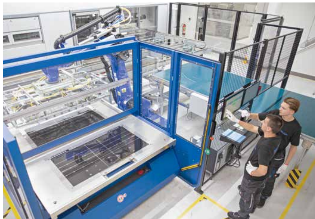
Die Thermoformanlage für bedruckte Bogenware arbeitet vollautomatisiert.
