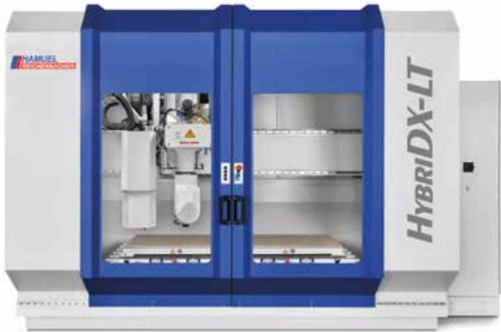
Die HybriDX-LT von Reichenbacher Hamuel kombiniert industriellen 3D-Druck mit 5-Achs-Bearbeitung.
