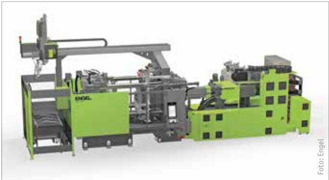
Eine Engel duo 700 zeigt die Kombination aus dekorativem Folienhinterspritzen und funktionalem PUR-Überfluten für eine Rückleuchte. Das übliche Lackieren entfällt.
