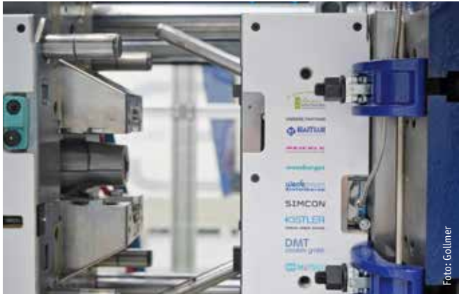
Turnkey-Anlagen von Gollmer vereinen Spritzgießmaschine und Form zu einem produktionsbereiten Gesamtsystem.
