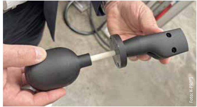
Foto: K-PROFI Von Kegelmann gedruckter Schwimmer aus Lauramid für eine Pumpe im eigenen Maschinenpark. Handtmann bietet sowohl Lauramid-Filamente an als auch daraus additiv gefertigte Bauteile.
