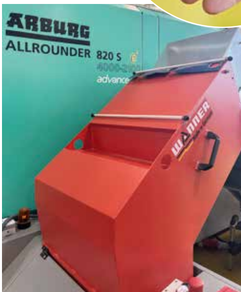
Die größte Beistellmühle an der größten Spritzgießmaschine: Wo es möglich ist, wird der Anguss wiederverwendet und dazu bereits in Musterteilen mit entsprechenden Anteilen validiert.
