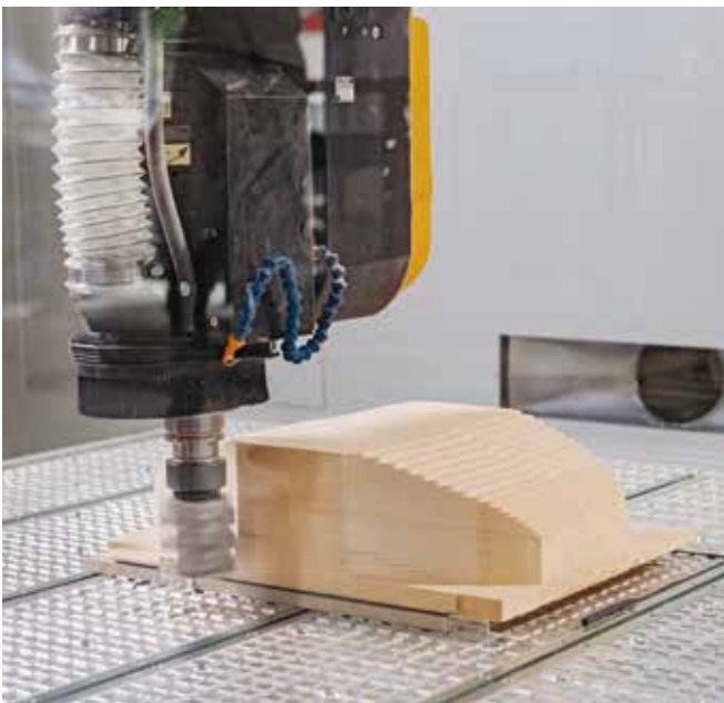
Die Explora Multi pro 3015 im Showroom bei Biesse arbeitet mit 24 Werkzeugen. Der Werkzeugwechsler fährt oben in der Maschine mit.
