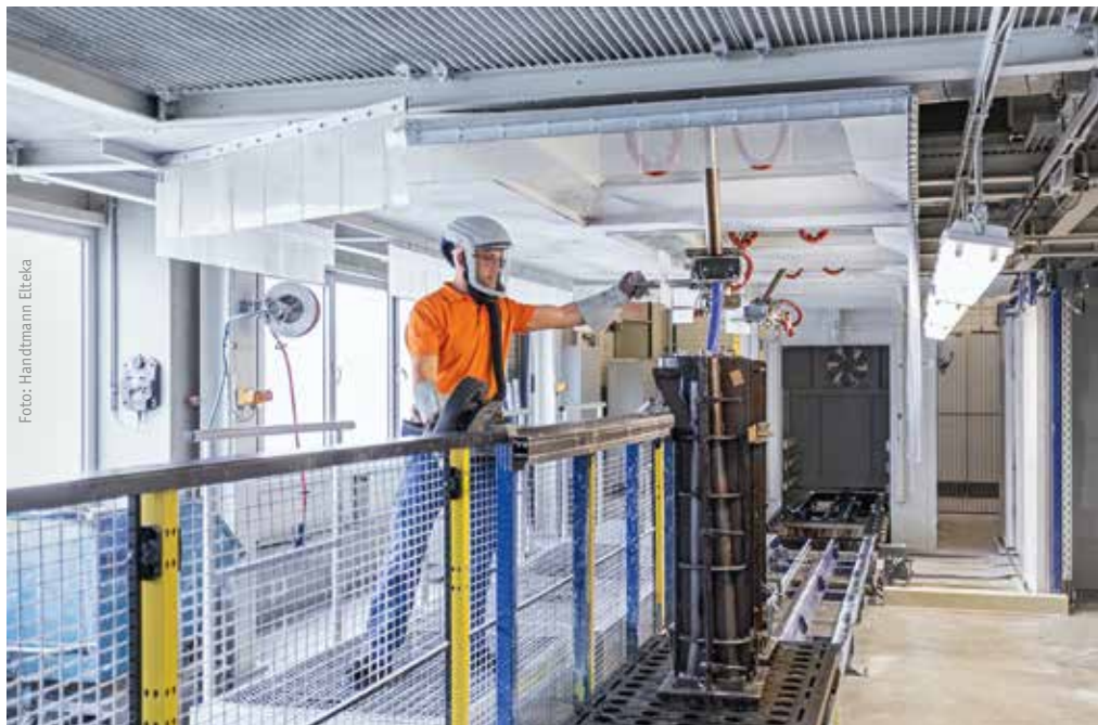
In der teilautomatisierten Gießanlage werden die Formen auf einem Palettenträger transportiert. Ein Mitarbeiter füllt die Form mit dem passend ausgegebenen Schmelzevolumen.
