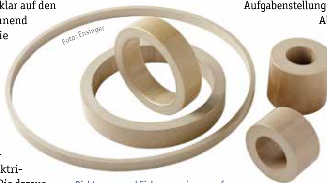
Dichtungen und Sicherungsringe aus faserverstärktem PEEK eignen sich aufgrund ihrer hohen mechanischen Eigenschaften und Chemikalienbeständigkeit für Offshore-Anwendungen.
