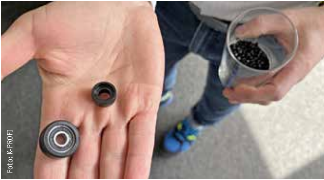
Foto: K-PROFI Aus dem spritzgießfähigen Regranulat Lauramid Inject fertigt das Schwesterunternehmen Kegelmann kleinformatige, funktionale Spritzgussteile in hohen Losgrößen.
