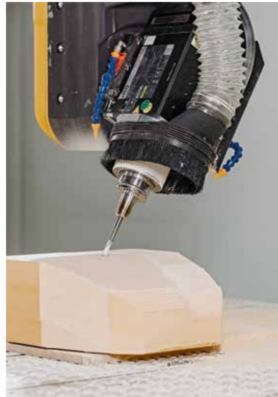
Die Maschine Explora Multi pro 3015 kann Bauhöhen bis zu 950 mm bearbeiten.
