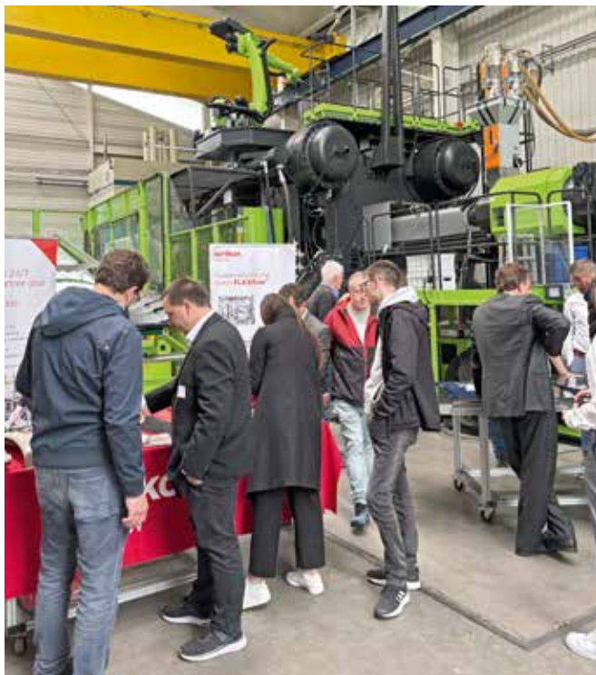
Eine von zwei 40.000-kN-Zweiplattenmaschinen im Technikum: Zur Hausmesse präsentierte Oerlikon HRSflow auf der Engel 4000 Duo sein servo-angetriebenes Nadelverschluss-System Flexflow mit der Produktion eines Automotive-Spoilers.
