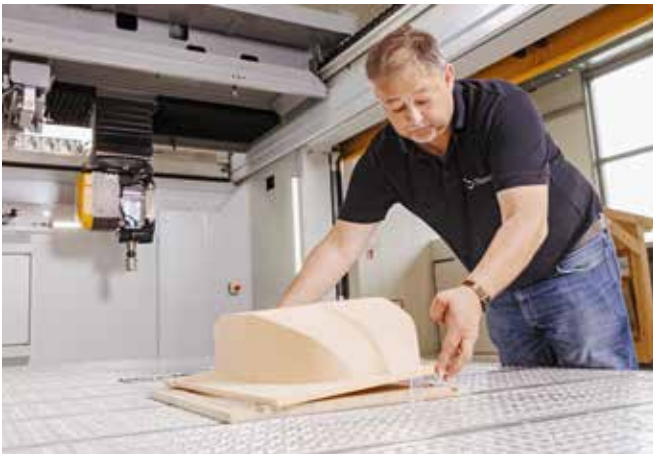
Marek Flatzek platziert den Ureol-Block, aus dem das Werkzeug für eine Komponente des CFK-Frontflügels entstehen soll, im 5-Achs-CNC-Bearbeitungszentrum Explora Multi pro 3015.
