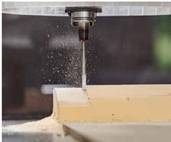
Danach geht es an die Feinarbeit. Nach und nach schält sich das Werkzeug für den Frontflügel heraus.
