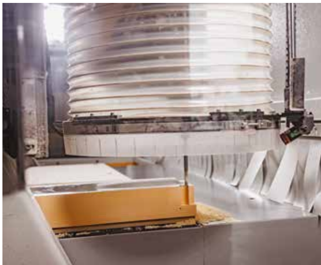
Zunächst trägt die Explora Multi up 1532 das Material bis auf 2 mm Aufmaß vom Ureolblock ab.
