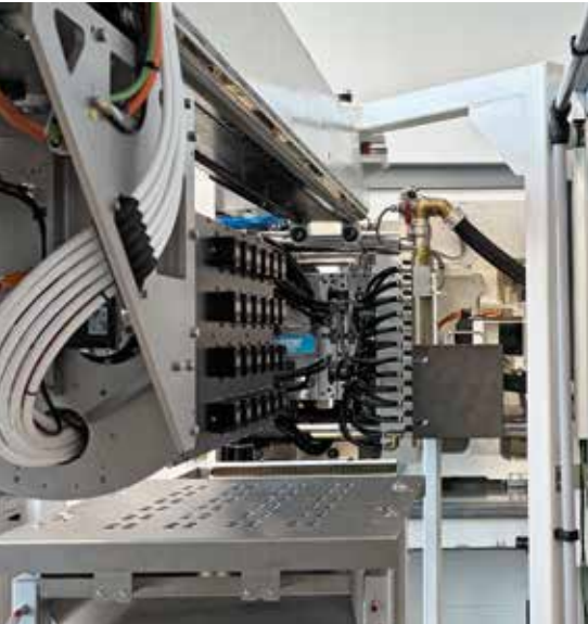
Das Automationskonzept von Micro Automation basiert rein auf Lineartechnologien, die eine hohe Wiederholgenauigkeit sicherstellen.
