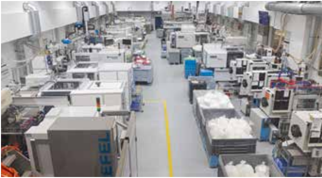
In mehreren Reinraumhallen arbeiten 70 Spritzgießmaschinen mit automatisierter Formteilentnahme und integrierten Prüfroutinen.
