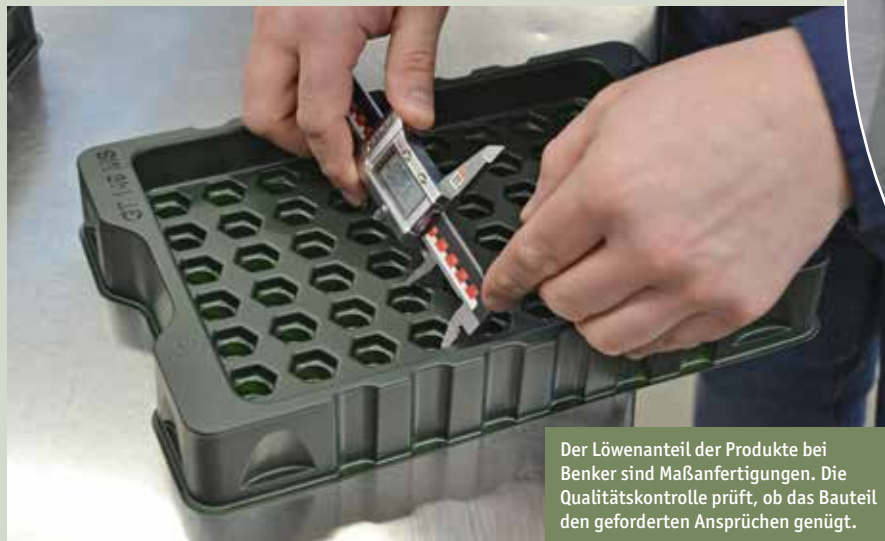
Die Transportverpackung für die Druckluftnippel trägt mit nur 60 g Eigengewicht die insgesamt 1.200 g schwere Ladung problemlos. Bis zu zehn der Trays lassen sich übereinander stapeln.
