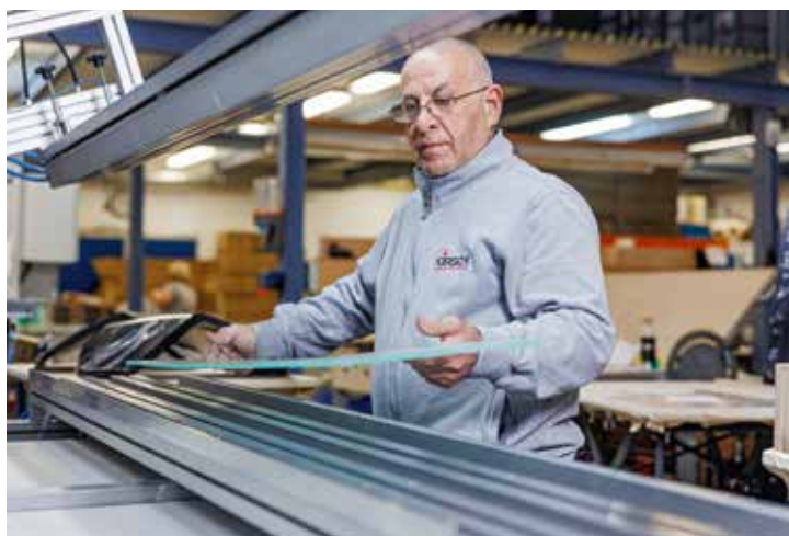
Der Mitarbeiter erwärmt das hochtransparente PC-Halbzeug linear in der Biegemaschine ...
