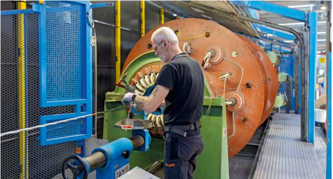
Zweilagige Verseilverbunde aus mehreren Kabeln entstehen in sogenannten Korbverseilern.
