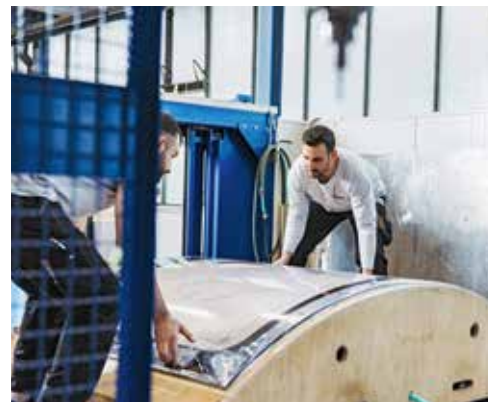
Zwei Mitarbeitende entnehmen ein fertig gefrästes Bauteil aus der Werkstückaufnahme des CNC-Bearbeitungszentrums.
