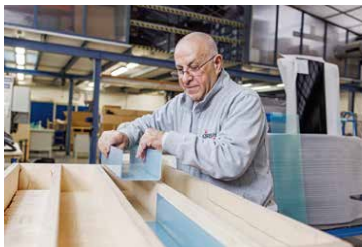
... und verformt es im Anschluss in der Biegeschablone zu Hauben für ein zahnmedizinisches Gerät.
