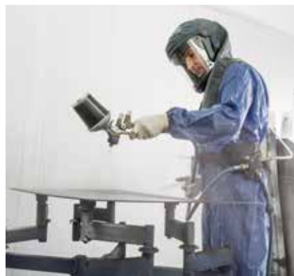
Vorab geformte Bauteile erhalten in der Lackierkabine das gewünschte Farbdesign.
