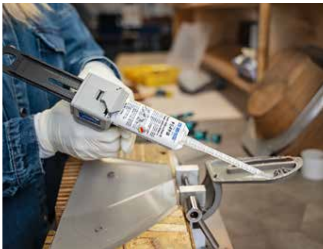
Eine Mitarbeiterin klebt zwei Elemente einer Klappe aus PP für ein Flaschenfach in einer Landmaschine. Die Unterseite ist in der Klebevorrichtung fixiert, auf die umlaufende Klebefläche des Oberteils trägt sie manuell den Klebstoff auf, nachdem sie die Bauteile vorab mit einem Oberflächenreiniger gesäubert hat.
