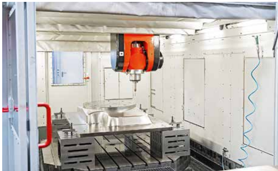
Das Werkzeug für Windleithauben für die Rotoren von Mähdreschern wiegt 40 t und besteht aus zwei Düsen-seiten. Verschiedene Einsätze ermöglichen es, unterschiedliche Modellvarianten zu spritzen.
