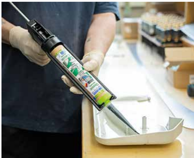
Ein Mitarbeiter verklebt den Spoiler einer Landmaschine aus ASA. Klebstoff der Wahl ist in diesem Fall ein MS-Polymer-Klebstoff.
