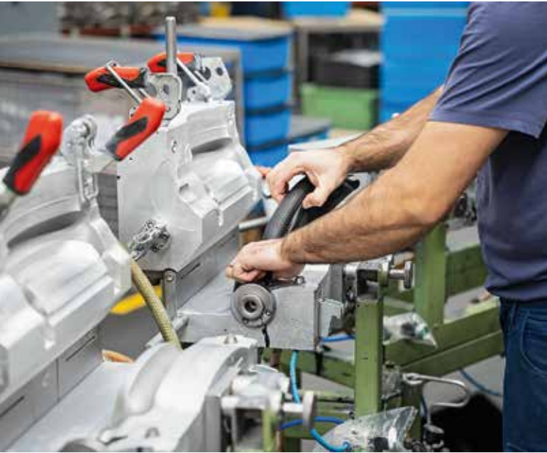
Die Kerne für die Bügelgriffe spritzt das Unternehmen aus PA6-GF35 im Gasinnendruckverfahren.
