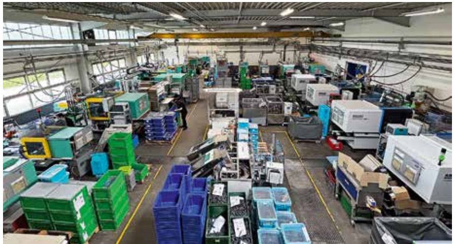
Am Standort Ottersweier produzieren 28 Spritzgießmaschinen mit bis zu 6.000 kN Schließkraft Komponenten und Baugruppen sowohl für Schwesterunternehmen als auch für externe Kunden.
