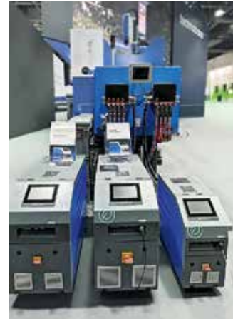
Live-Anwendung mit aufeinander abgestimmter Temperierung und Wassermengenverteilung
