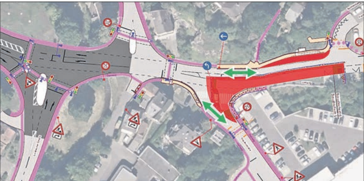
Verkehrsregelung im Bauabschnitt 5b, Phase 2/3: Seit Mitte August: Beschränkungen der Zu- und Ausfahrt Staufenstraße und längere Wartezeiten wegen der Umlauf-Ampel. Skizze: Hessen Mobil
