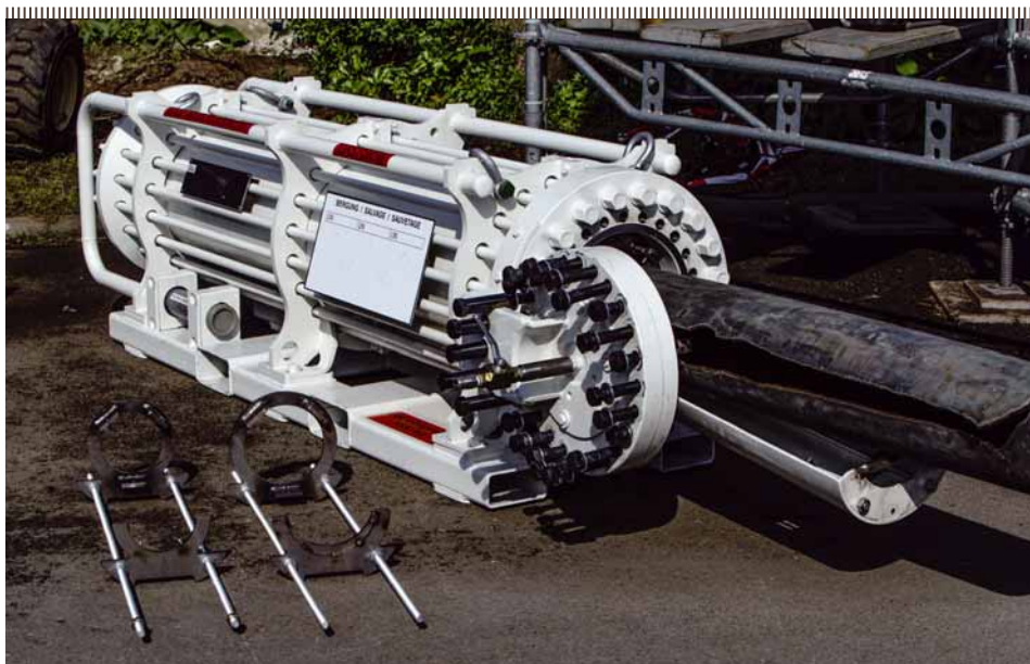
Mit Spezialgerät, wie hier einem Druckbehälter zur Bergung von Gasflaschen, helfen die TUIS-Werkfeuerwehren bei Transportunfällen mit Chemikalien.
