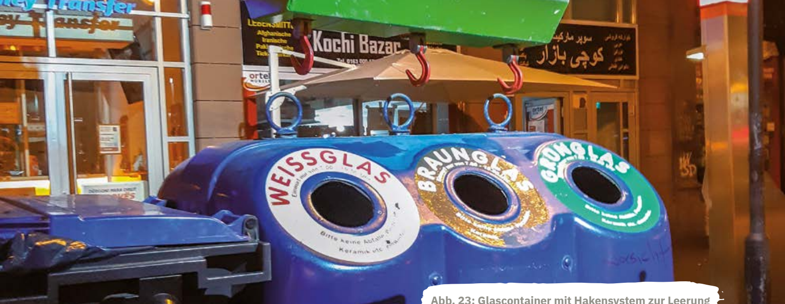
Abb. 23: Glascontainer mit Hakensystem zur Leerung
